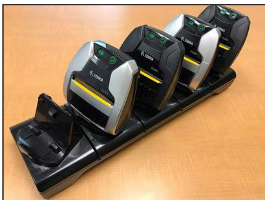
Figura 9 • Base de carga de cinco baias
