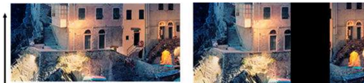
Original Digitalização afetada por um módulo CIS com defeito
