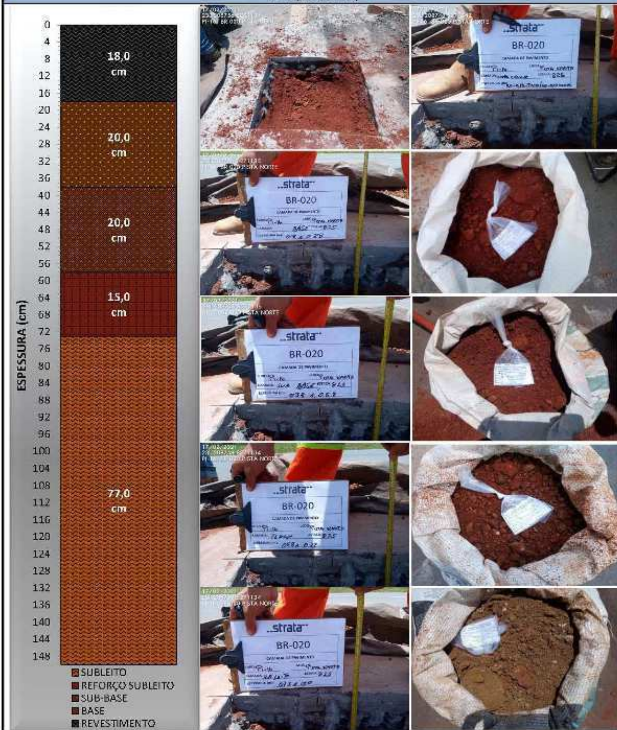
Figura 20: Relatório Fotográfico – PI-16 (Pista Norte)
