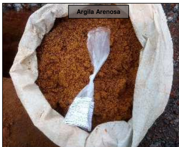
Figura 55: Camada de Sub-Base - PI-31 (Est. 525)
