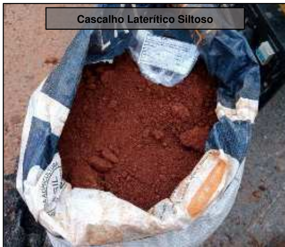
Figura 53: Camada de Sub-Base - PI-10 (Est. 525)
