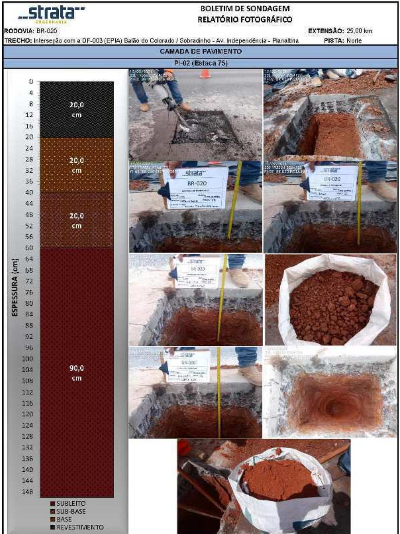
Figura 06: Relatório Fotográfico – PI-02 (Pista Norte)
