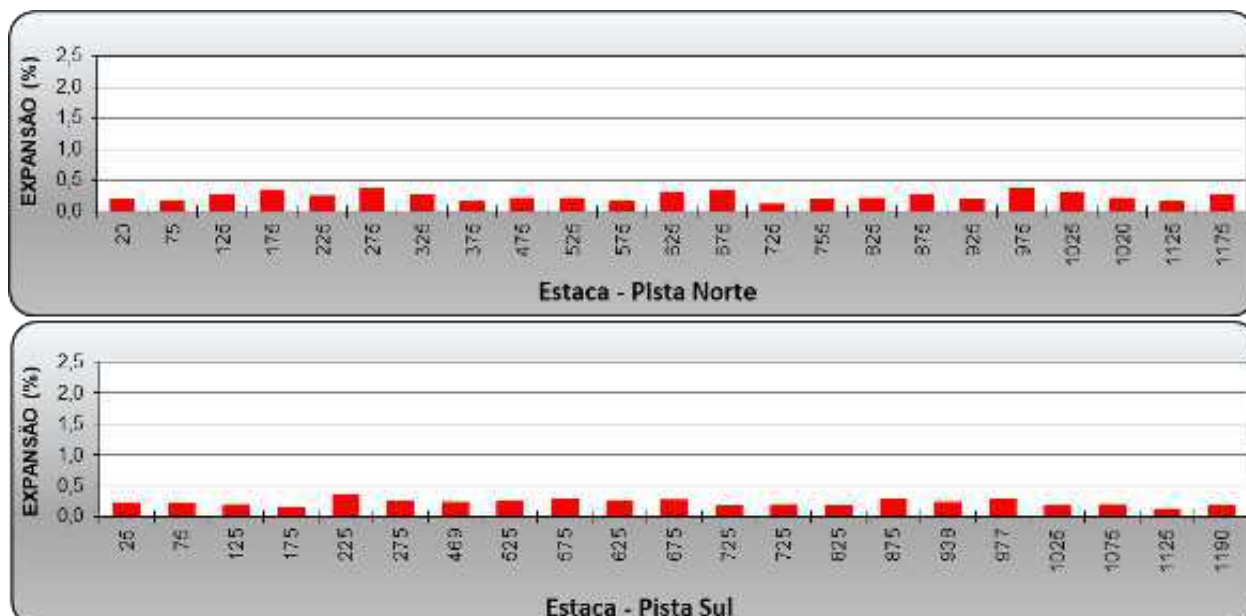
Figura 72: Resultados de Expansão da Camada de Base
