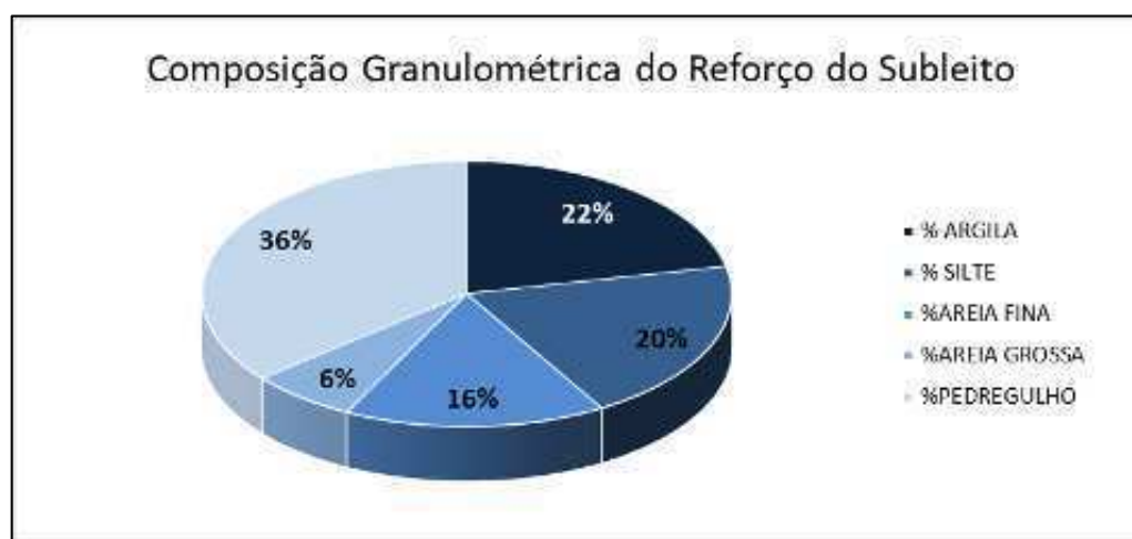
Figura 85: Gráfico da Composição Granulométrica do Reforço do Subleito
