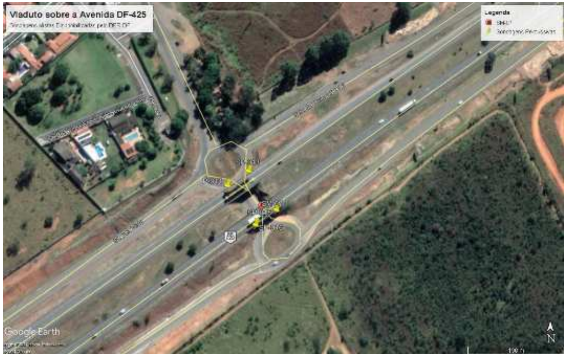
Figura 101 – Alocação das sondagens executadas próximo ao Córrego Mestre D’Armas.
