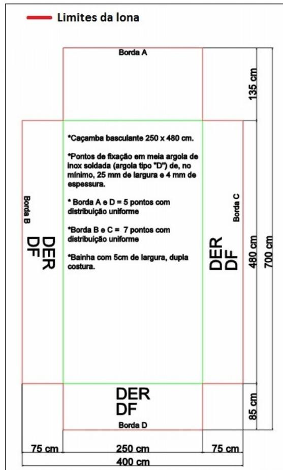
Fig. 01 - Croqui com as dimensões das lonas enceradas e em PEAD. Conforme mostrado, a distribuição dos pontos de fixação, são: na borda A e D - 5 pontos com distâncias uniformes e na borda B e C - 7 pontos com distâncias uniformes.
