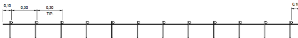
ESPAÇAMENTO ENTRE SUPORTES BARRAS DE TRANSFERÊNCIA - PLACA 3,5 x 4 m ESC. 1: 12,5
