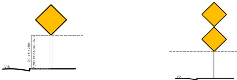
**Figura 2 - Advertência – Estrutura em Poste Metálico**
