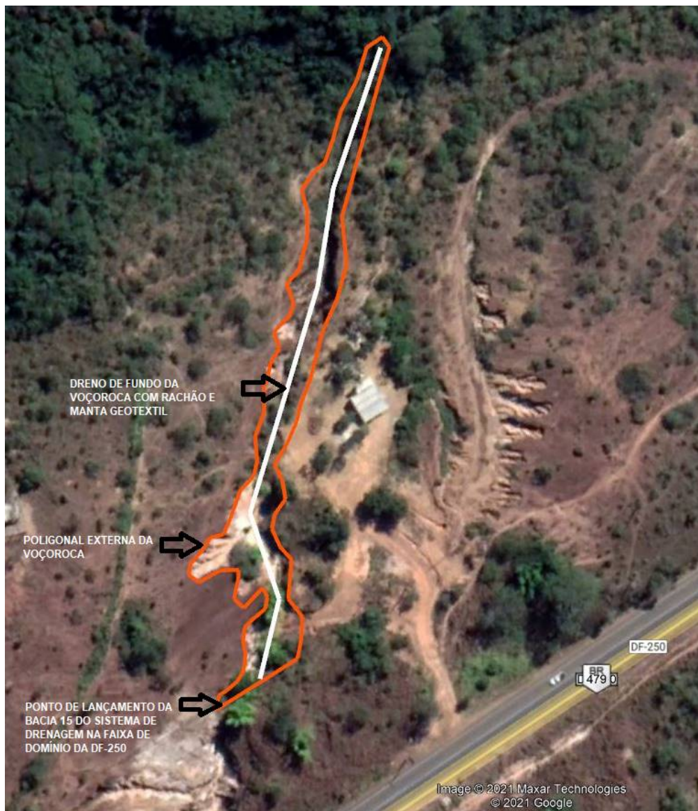
Figura 20: Delimitação da poligonal da voçoroca e eixo do dreno de fundo. Fonte: Elaboração própria.
