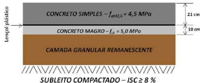
Obs.: 1) Placas modulares de 4,00 m x 3,60 m (pista e 3ª faixa) e 4,00 m x 2,50 m (acostamento) – com variações ocasionais – dotadas de barras de transferência nas juntas transversais (aço CA-25) e barras de ligação (aço CA-50) nas juntas longitudinais, cujos pormenores constam do projeto geométrico e da planta de detalhes de juntas.
