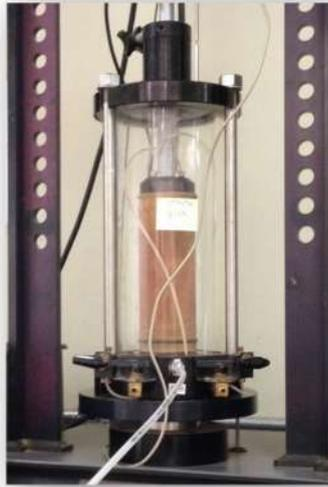
Figura 39 - Ensaio Triaxial para determinação da deformação permanente no solo de fundação
