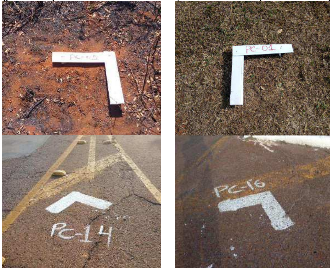
Figura 4. Exemplos de Pontos de Controle - PCs, foto identificáveis implantados em campo.
