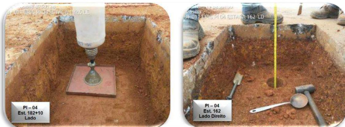
Figura 24: Visualização dos materiais constituintes das camadas de base e subbase existentes
