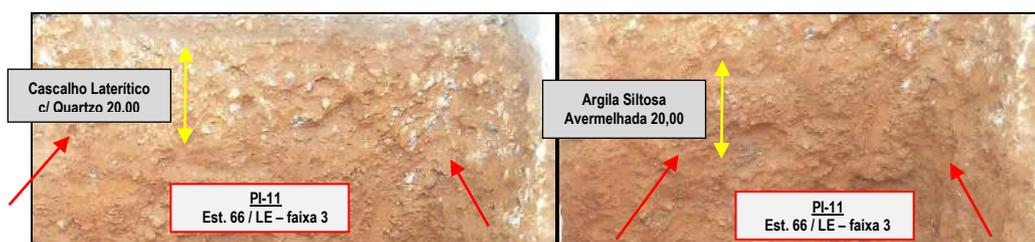
Figura 69: Visualização dos materiais constituintes das camadas de base e subbase existentes
