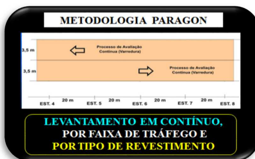
Figura 4 - Processo de levantamentos das degradações superficiais por faixa de tráfego e em contínuo
