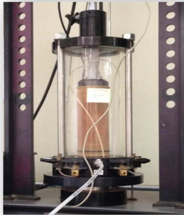
Figura 32 - Ensaio Triaxial para determinação da deformação permanente no solo de fundação
