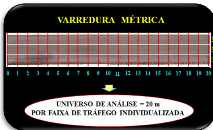
Figura 6 - “Varredura métrica” das degradações superficiais, por estaca e por faixa de tráfego
