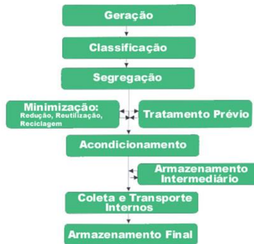
Figura 1- Fluxograma do processo produtivo
