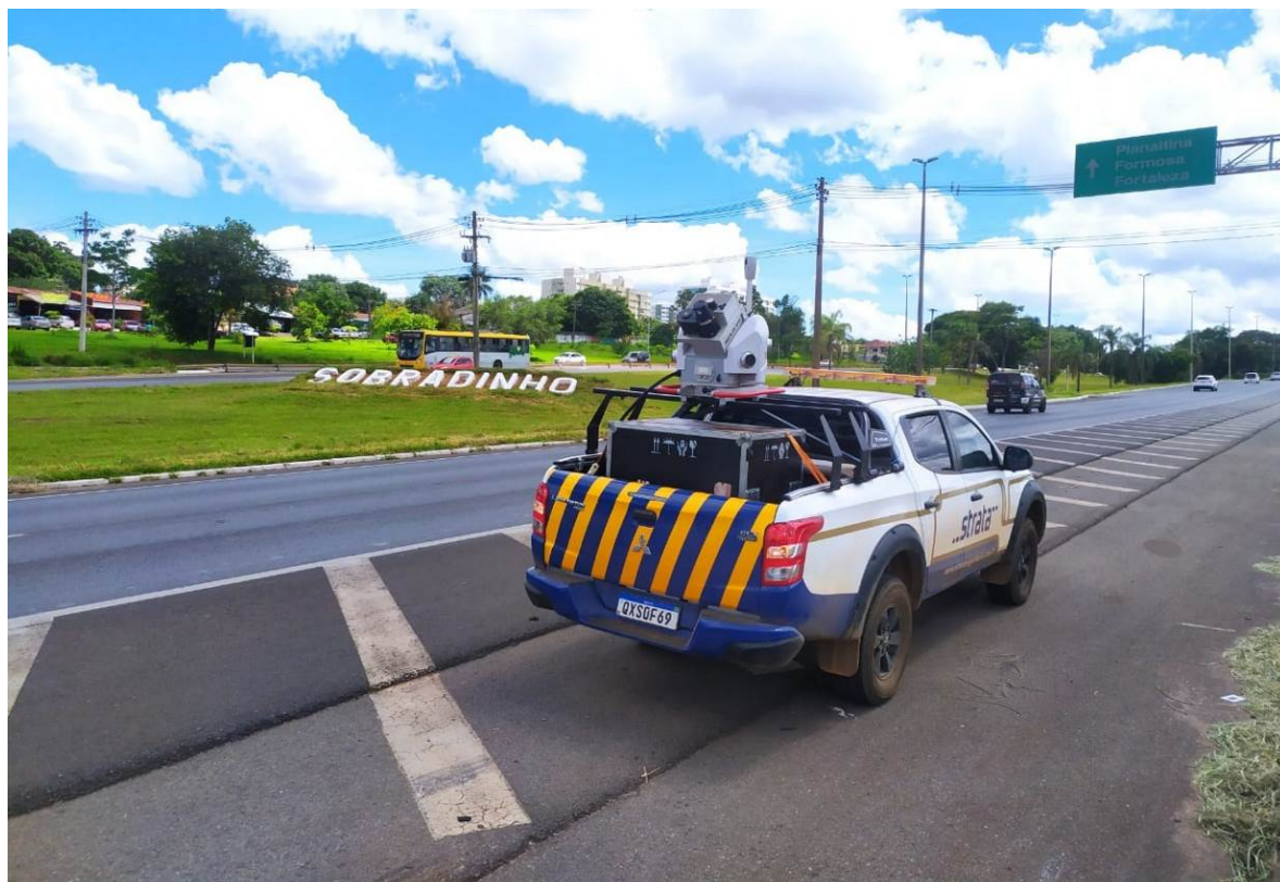
Figura 27 - Sistema de Mapeamento Terrestre a laser scanner (LIDAR)
