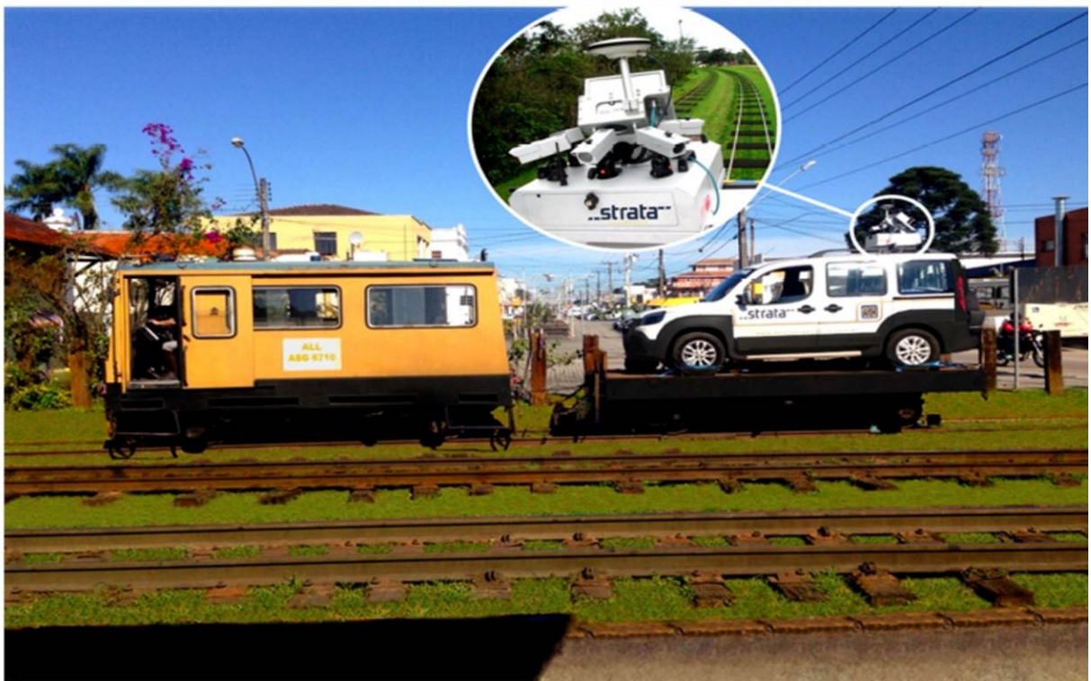
Figura 3 - Equipamento montado em veículo rebocador ferroviário
