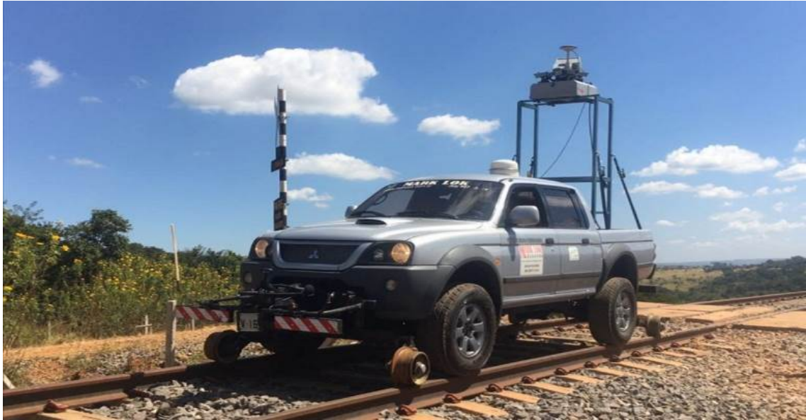
Figura 2 - Equipamento montado em veículo rodoferroviário
