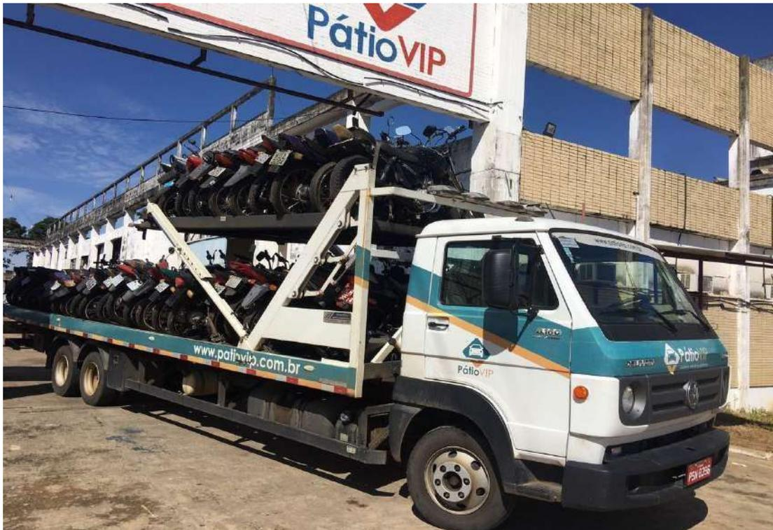
Figura 18: Foto exemplo de um guincho leve (Fonte: Elaboração própria)
