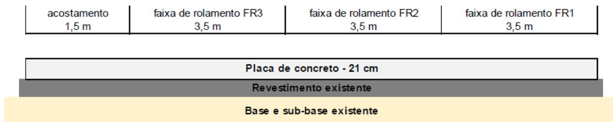
**Figura 1** Seção Transversal Tipo / Pavimento Rígido Whitetopping
