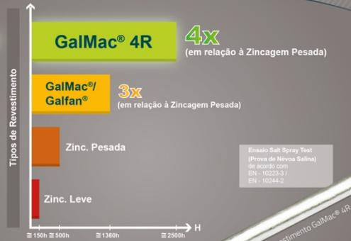
Ensaio Salt Spray Test (Prova de Névoa Salina) de acordo com: EN 10223-3 / EN 10244-2
