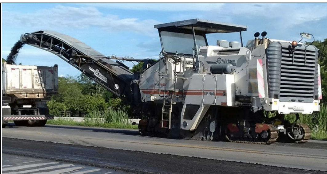
**57 – Caso ocorra nas faixas de tráfego a patologia de afundamento de trilha de roda maiores do 50 mm, serão necessários serviços de fresagem a frio do revestimento asfáltico, com posterior recomposição. (Fonte: Imagens da Internet)**
