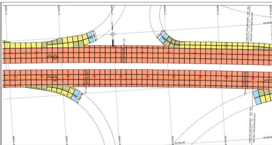
**60 – Os detalhes em azul são exemplos de transições do pavimento de concreto para o para o revestimento flexível, estas situações ocorrem nas alças de entrada e saída da DF-095, inclusive nas alças dos Viadutos. Nestes referidos locais serão necessários serviços de aplicação de Concreto Asfáltico Usinado a Quente (CAUQ), conforme foto a seguir. (Fonte: Projeto de Restauração da DF-095 – Empresa CRG Engenharia)**
