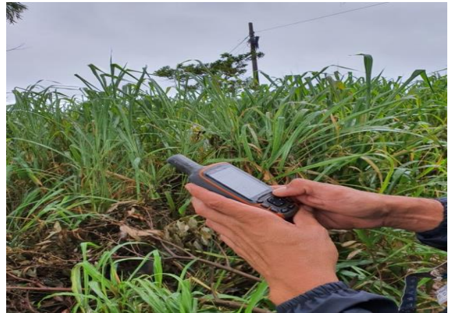
Foto 2: Registro de coordenadas planialtimétricas de todos os indivíduos arbóreos com interferência sobre as bacias de retenção a serem instaladas na faixa de domínio da rodovia VC-371.
