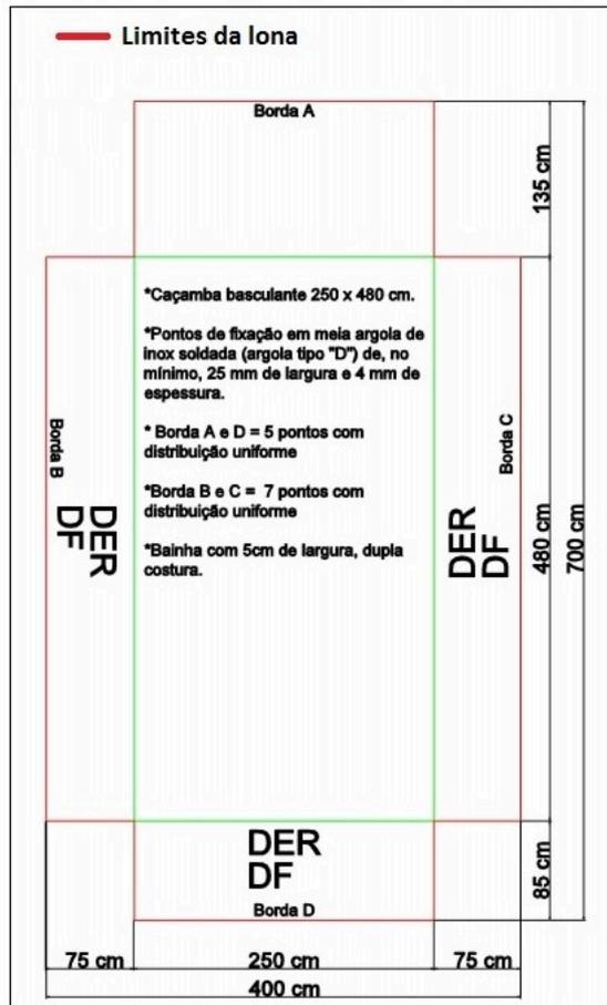
Fig. 01 - Croqui com as dimensões das lonas enceradas. Conforme mostrado, a distribuição dos pontos de fixação, são: na borda A e D - 5 pontos com distâncias uniformes e na borda B e C - 8 pontos com distâncias uniformes.
