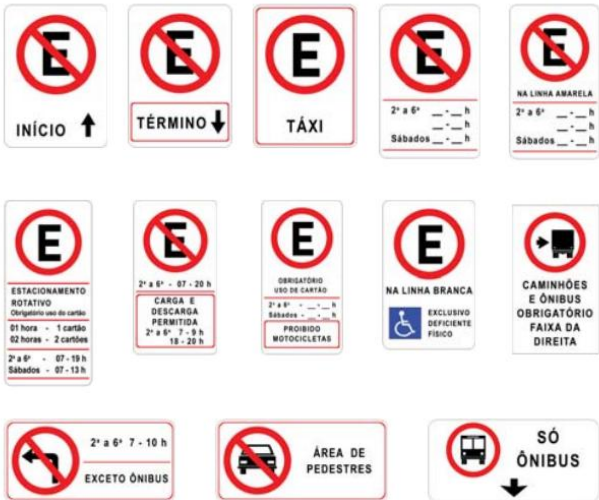
Figura 11 – Exemplo da sinalização vertical de regulamentação com informações complementares. Fonte: CONTRAN, 2007a.
