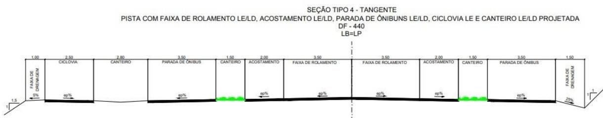
**Figura 4– Seção Tipo 4 – Tangente (trechos com parada de ônibus)**
