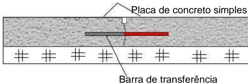
**Figura 11 – Placas de concreto simples com barras de transferência.**
