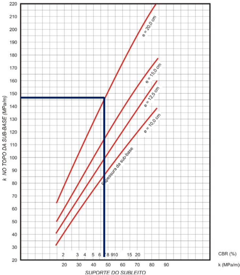
**Figura 12** - Aumento de k devido à presença de sub-base granular.
