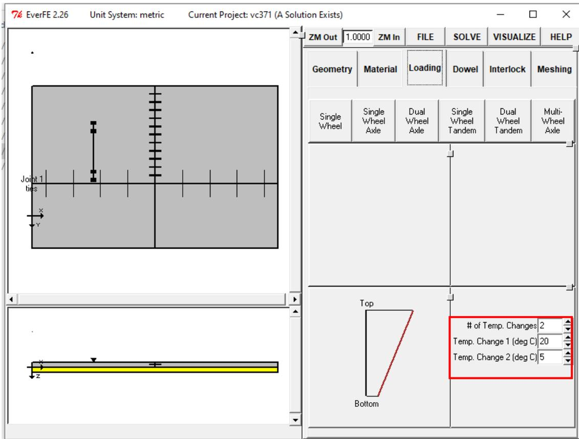
Figura 14 – Amplitude térmica considerada. 20°C para parte superior e 5°C para inferior da placa.
