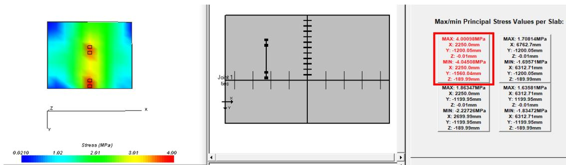
Figura 15 – Tensões máximas e mínimas encontradas na parte inferior da placa.
