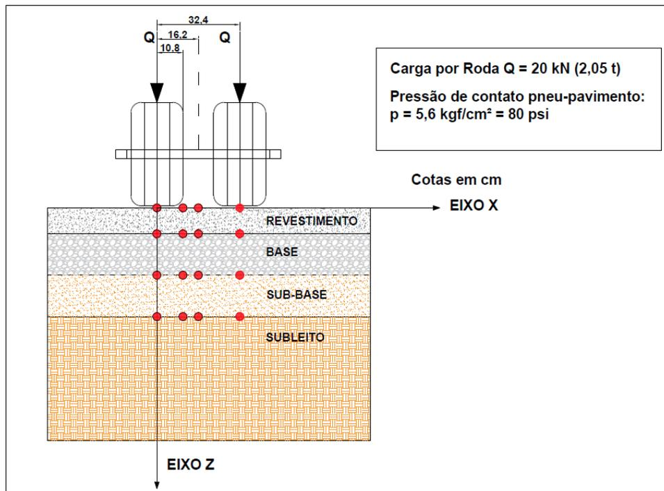
**Figura 62: Modelo estrutural considerado nas análises mecânicas.**
