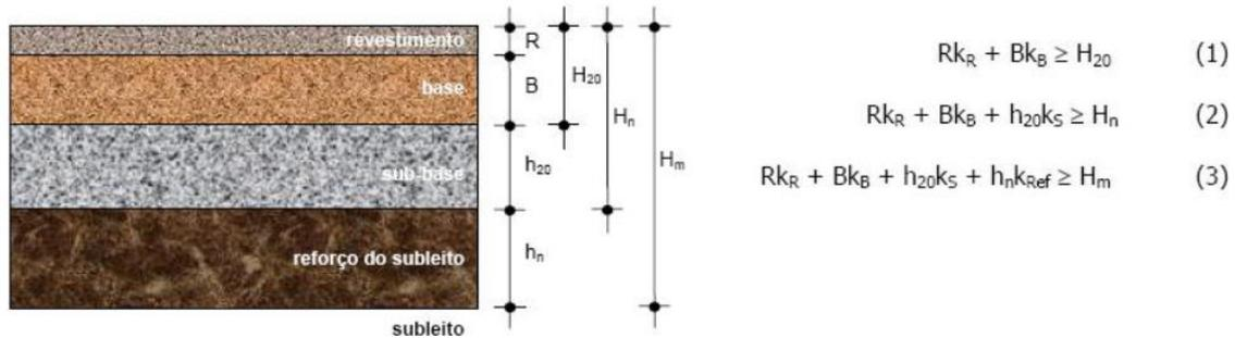
Figura 9: Dimensionamento de Pavimentos Flexíveis – Método Empírico.
