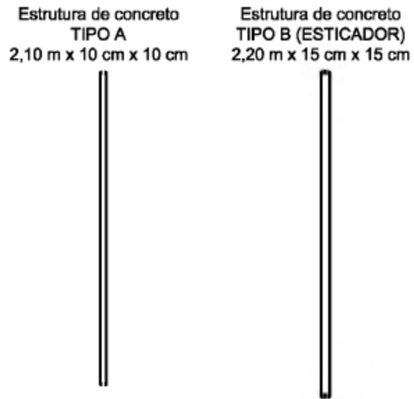
Fig. 03 – Detalhes do projeto do alambrado para direcionamento de fauna.
