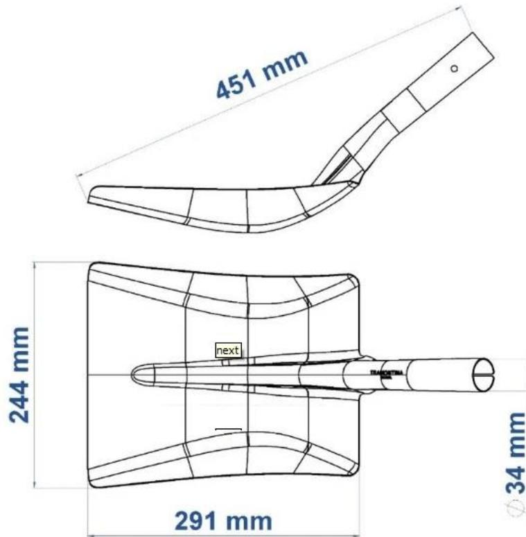
Fig. 01 - Dimensões para a pá quadrada em aço;
