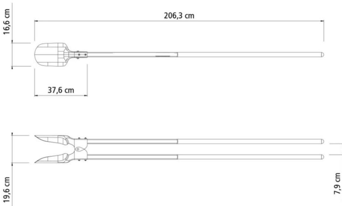
Fig. 02 - Dimensões para a cavadeira articulada manual em aço.
