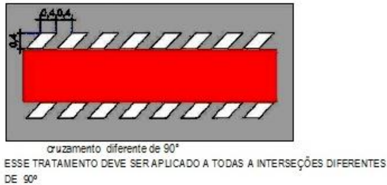
Figura 10.3 - Marcação de Cruzamento Rodociclovitário em ângulo oblíquo – COMP. DE ENGEN.DE TRÁFEGO/SP.
