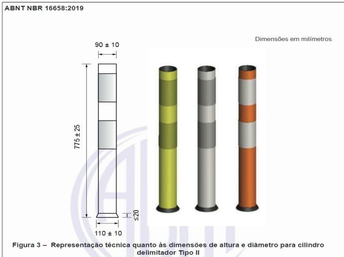
Fig. 01 - Imagem dos balizadores do Tipo II, referentes a ABNT 16.658/2019.
