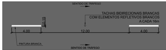
FAIXA SECCIONADA BRANCA MARGINAIS 60km/h
