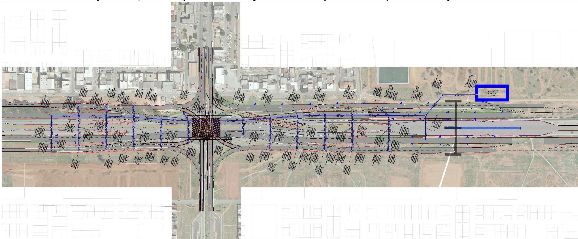
Figura 12 - Mapa de localização da rede de drenagem e bacia de detenção a ser instalada para as faixas marginais e OAE.
