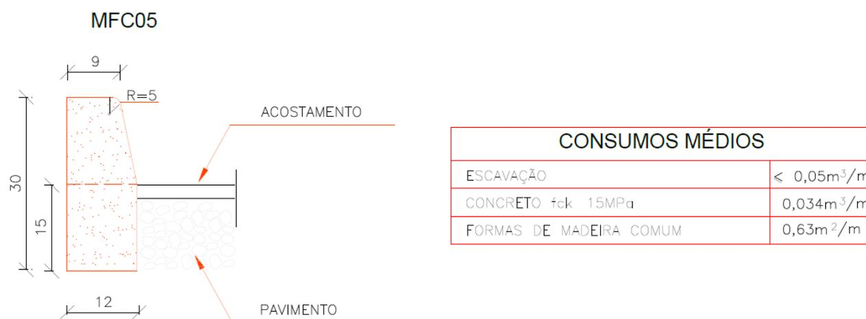
**Figura 11.1 – Meio Fio MCF 05 padrão DNIT**
