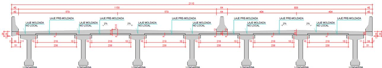
**Figura 4.1 - Seção Transversal do Viaduto**
