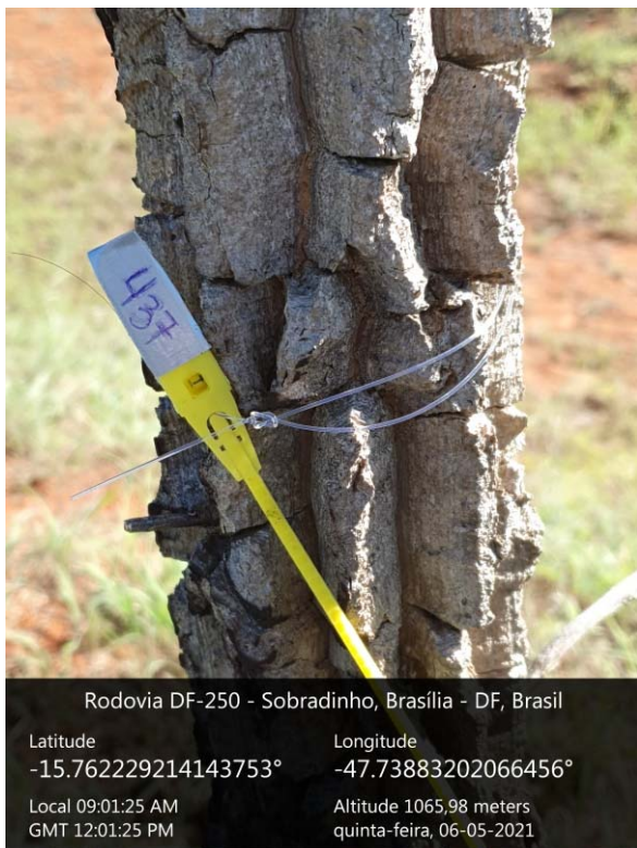
Figura 12: Lacre plástico numerado utilizado para marcação amarrados com linha de nylon. Fonte: PRISMA.
