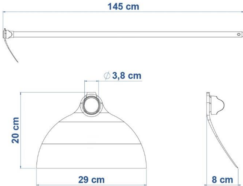
Fig. 01 - Dimensões para a enxada larga em aço;
