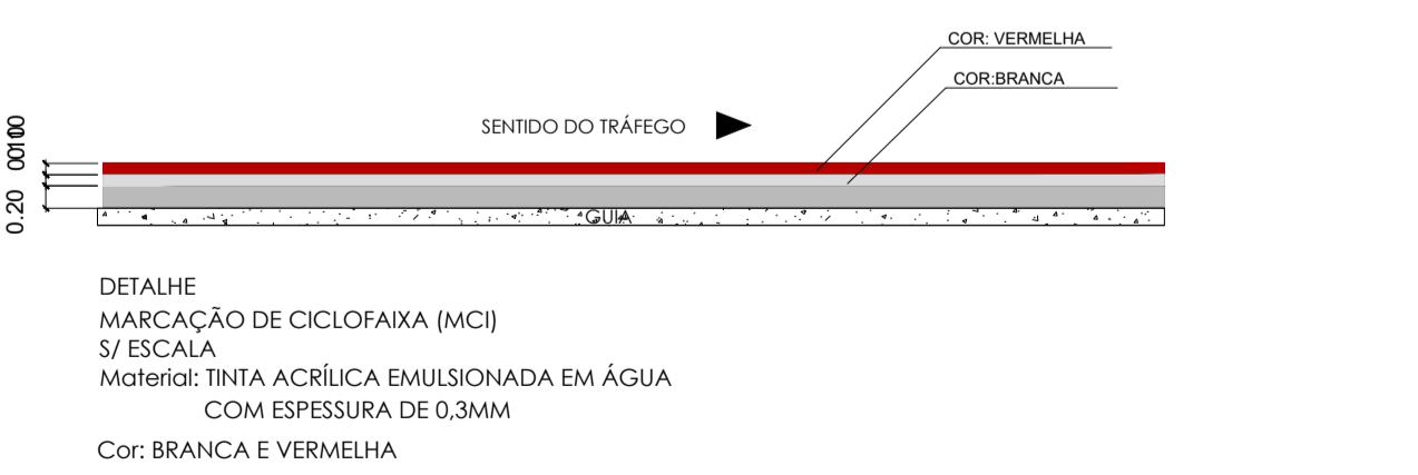
DETALHE MARCAÇÃO DE CICLOFAIXA (MC) S/ ESCALA Material: TINTA ACRÍLICA EMULSIONADA EM ÁGUA COM ESPESURA DE 0,3MM Cor: BRANCA E VERMELHA
