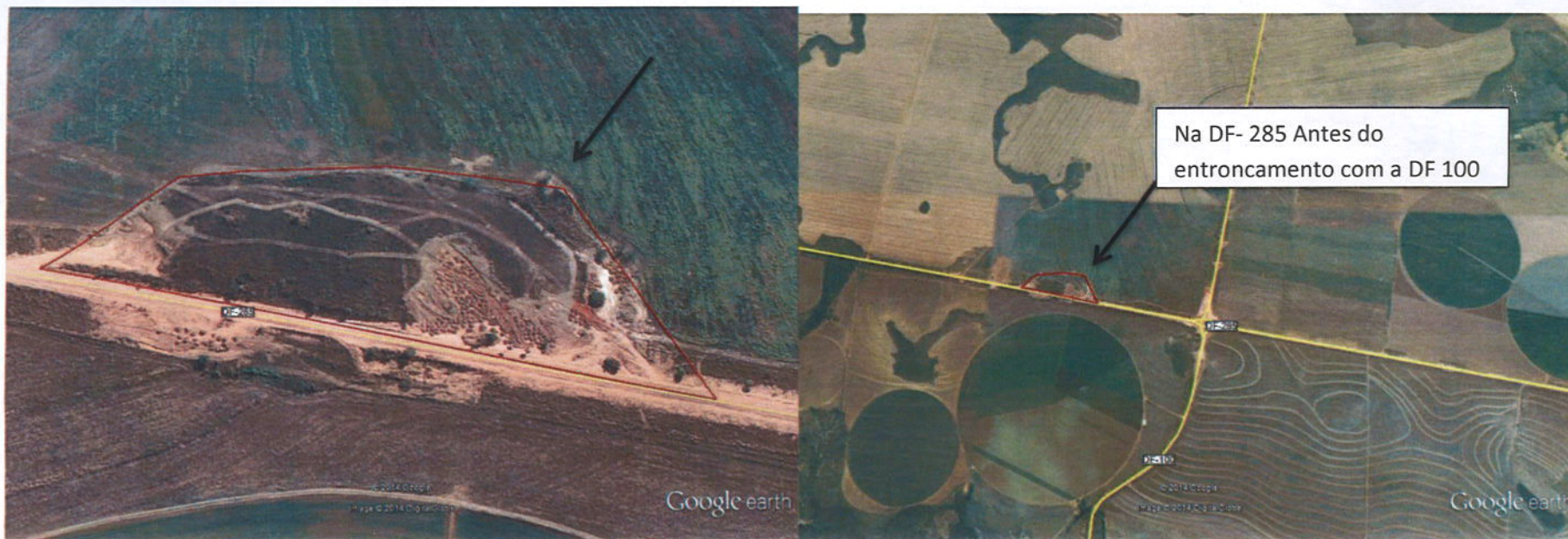
LOCALIZAÇÃO DA OCORRÊNCIA DE CASCALHO QUE INTERESSA À GETEC PARA COMPOR A ESTRUTURA DO PAVIMENTO DA DF-285.
