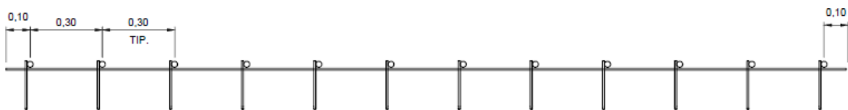
Figura 5 Sistema de Apoio das Barras de Transferência - Espaçamento entre Suportes
