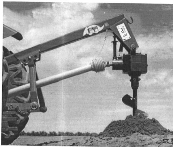
Brocas com diâmetro de 9, 12 e 18 polegadas. Os raspadores e o ponteiro das brocas são tratados termicamente, com endurecimento ideal para evitar desgaste acentuado. Sistema automático de alinhamento da broca, mantendo-a sempre na posição vertical, agilizando as operações.
